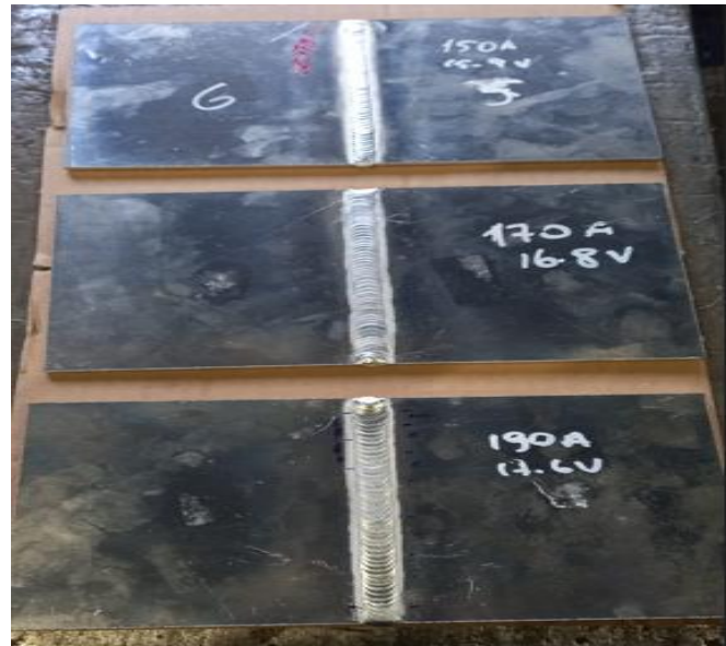
Görsel 2. Tig Kaynak Yöntemiyle Birleştirilen Plakalar
