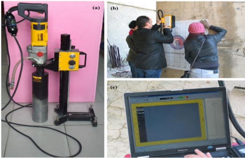
Görsel 2. (a) Karot makinesi, (b) Yüksek frekanslı antenle GPR ölçümü ve (c) Çevrimiçi GPR kaydı
