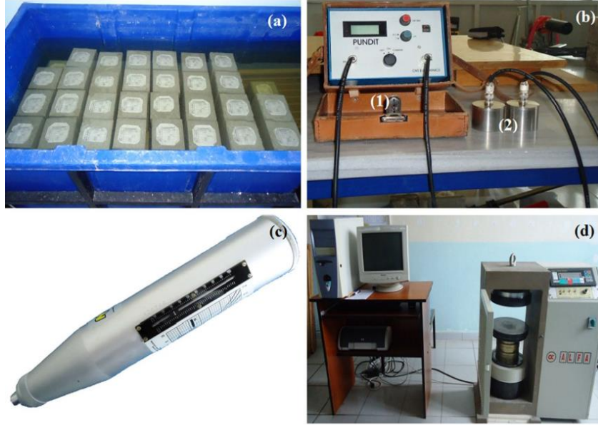
Görsel 1. (a) Numuneler ve numunelerin hazırlanmasında kullanılan ekipmanlar, (b) ultrasonik cihaz (1) ölçü birimini ve (2) verici ve alıcıyı gösterir, (c) Schmidt çekici, (d) kırma test ünitesi
