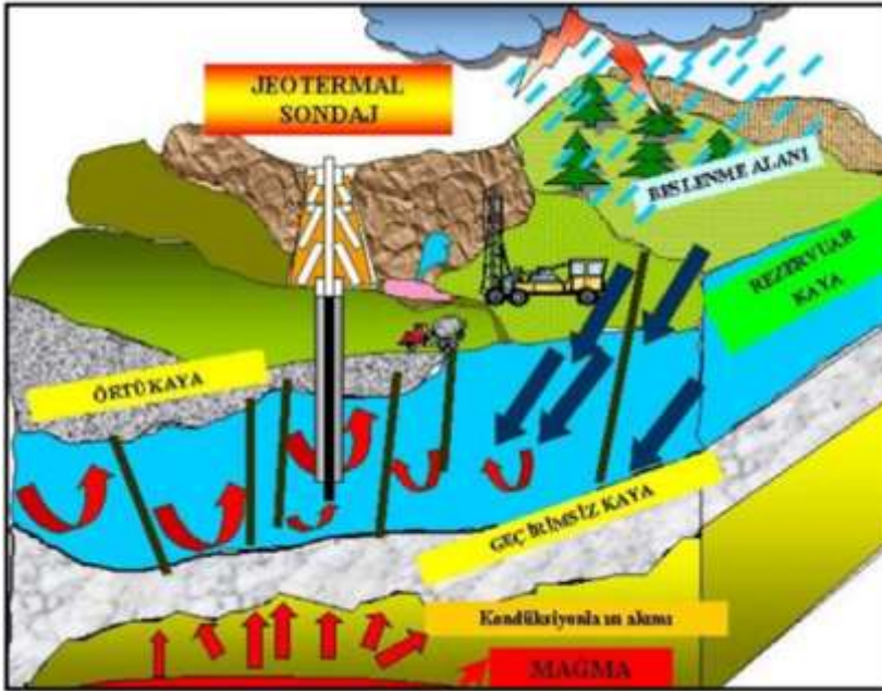
Şekil 1. Jeotermal sistemin oluşum modeli (Pekçetinöz, 2020).
