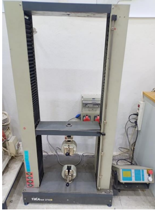
Görsel 2. Basma ve iç çekme mukavemeti deney cihazı.
