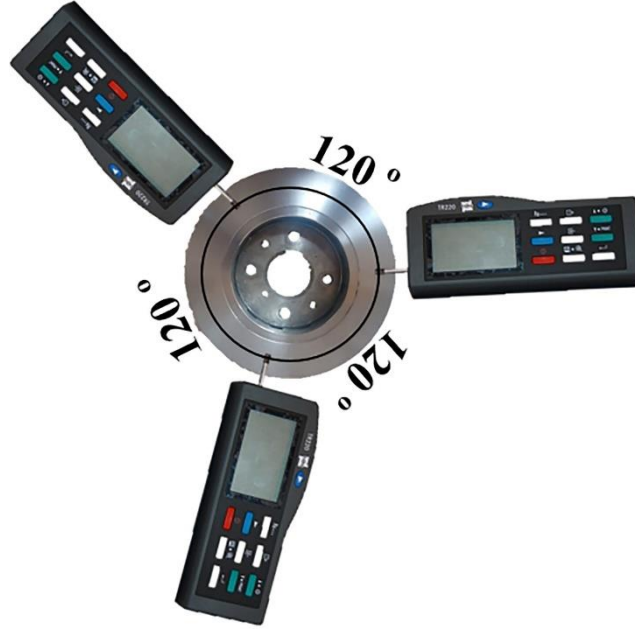
Görsel 1. Disk pürüzlülük ölçüm noktaları
